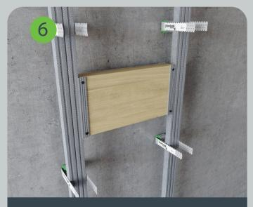
Выполняется установка закладных деталей в местах крепления тяжелых предметов интерьера или оборудования.
