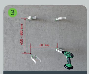
Крепятся виброизоляционные подвесы SoundGuard Vibro P с помощью дюбелей SoundGuard DR 6x60 и саморезов SoundGuard УН 4x80.
