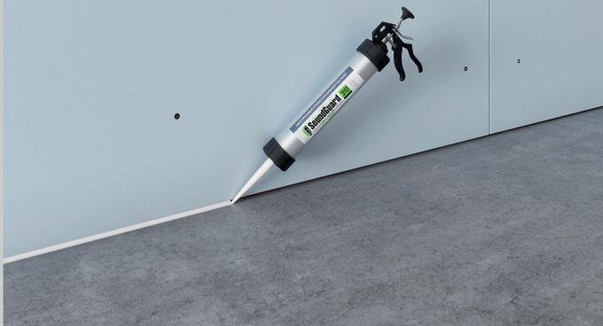
Между торцами листов гипсокартона и поверхностями пола, стен и потолка остается зазор 3 – 5 мм, который впоследствии заполняется герметиком SoundGuard Seal.
