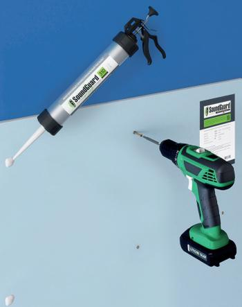
Шляпка саморезов утапливается в теле звукоизоляционного гипсокартона на 1 мм и промазывается герметиком SoundGuard Seal.
