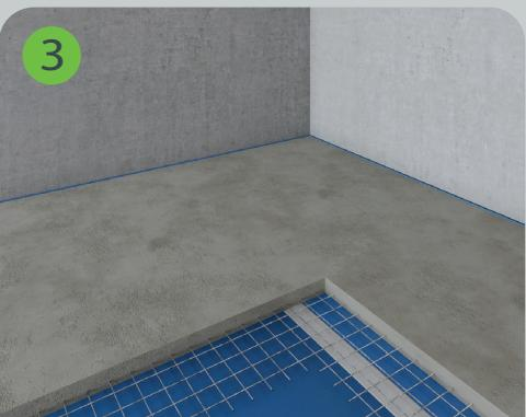
Поверх звукоизоляционного материала выполняется цементно-песчаная стяжка толщиной минимум 60 мм. Стяжка должна быть армирована сеткой в 1/3 ближе к низу слоя.
