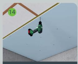
Гипсокартон Gipsofon монтируется совместно с мембраной и крепится к профилю без зазоров между листами саморезами SoundGuard XTN 3,9х41. Расход составляет не менее 17 шт./м². Шляпки саморезов слегка утапливаются.
