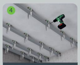
Потолочные профили SoundGuard Strong ПП 60/27 1-го уровня крепятся к виброизоляционным подвесам с помощью саморезов с буром 4,2x13. Шаг профилей 1-го уровня составляет 400 мм.
