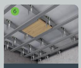
Выполняется установка закладных деталей в местах крепления тяжелых предметов интерьера или оборудования.
