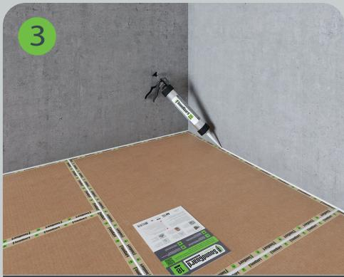
Все швы между панелями, а также места примыкания по периметру помещения к стенам заполняются герметиком SoundGuard Seal в процессе монтажа.
