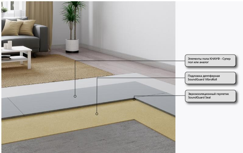
Самая тонкая система звукоизоляции для пола в линейке решений SoundGuard под финишное покрытие. Эффективно защищает от шума бытовых приборов, разговоров, плача ребёнка и лая собак, снижает ударный шум: звук шагов, падение предметов. Применяется, если на полу уже имеется стяжка и в помещении есть ограничения по толщине возводимой конструкции. Толщина системы: 23,5 мм. Индекс дополнительной звукоизоляции:  $L_{nw} \sim 18$  дБ
